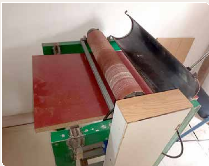
Máquina casera para rebajar la madera.
