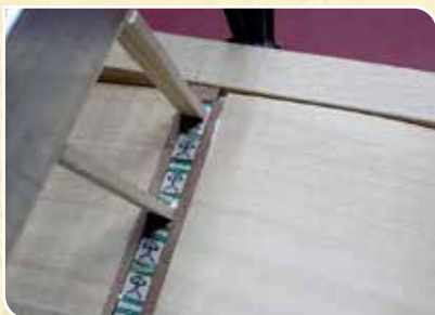
9. Construcción, ranurado, pegado y nivelado del diapasón (ébano)
