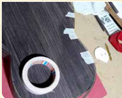
7. Instalación de perfiles
